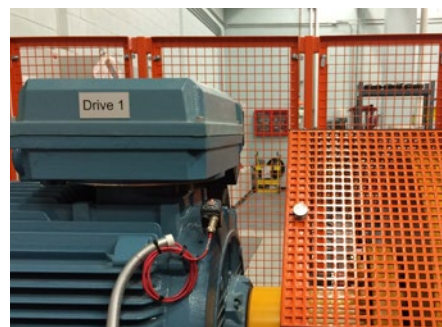
Überwachung der Motorschwingungen durch den FAG SmartCheck
