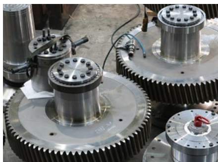
Le pignon, le plus lourd pèse presque cinq tonnes et a un diamètre extérieur de 1700 mm.
