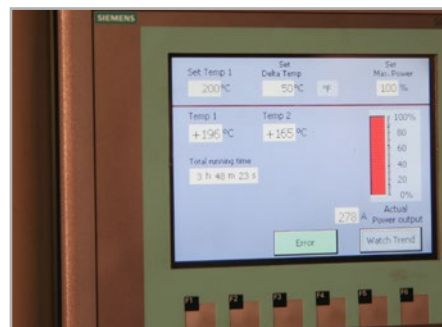
Le processus de chauffage est commandé par écran tactile sur le FAG Heater5000.
