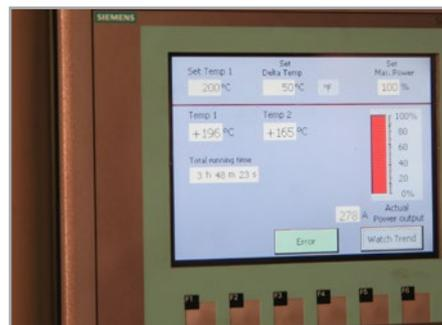
Der Anwärmvorgang wird über ein Touchscreen-Display am FAG Heater5000 gesteuert
