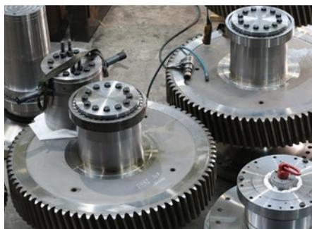
Das schwerste Zahnrad wiegt fast fünf Tonnen und hat einen Außendurchmesser von 1700 mm
