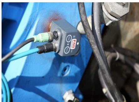
FAG SmartCheck mesurant les vibrations de la transmission
