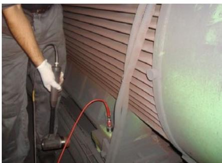
Posiciones del sensor en la bancada del motor para la prueba de impacto
