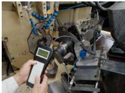
Der FAG Detector III ist ein handliches, einfach zu bedienendes Offline-Schwingungsmessgerät
