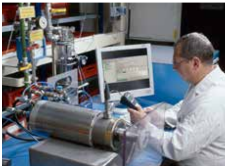
Manuelle Messung an einem Spindelprüfstand
