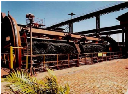
Pelletieranlage zum Befüllen der Rostwägen mit vorgeformten Pellets
