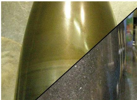
Los elementos rodantes antes/después del reacondicionamiento.
