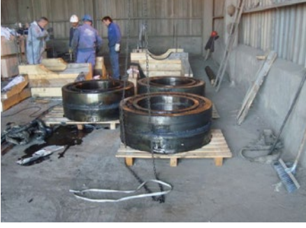
Rulmanların roller preslerden sökülmesi
