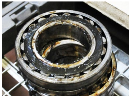
Una lubricación excesiva provoca el fallo del rodamiento
