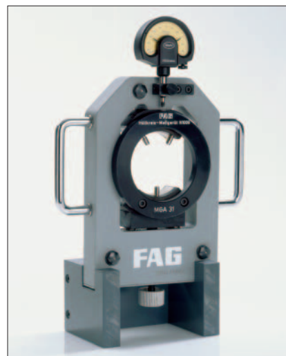
FAG kehähalkaisijan mittalaite MGA 31 irrotet- tavilla ulkorengailla varustettujen lieriörulla- laakereiden säteisvälyksen tai esijännityksen säättämiseen
