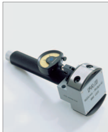
FAG kehähalkaisijan mittalaite MGI 21 irrotet- tavilla sisärenkailla varustettujen lieriörullala- kereiden säteisvälyksen tai esijännityksen säättämiseen
