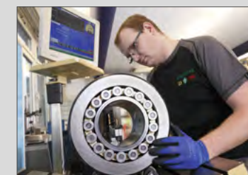
Inspección de los rodillos de apoyo
