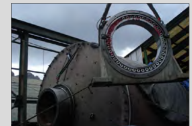
Para el montaje de grandes rodamientos se requiere conocimiento experto y herramientas especializadas
