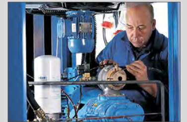
Mantenimiento de un compresor de hélice de Boge
