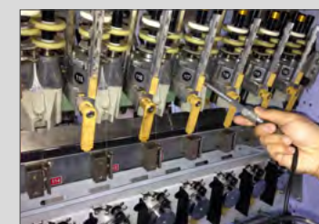
Prueba manual de vibraciones en las unidades de texturización con husillos de fricción
