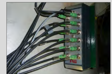
FAG SmartConnectBox permite la distribución de la alimentación eléctrica y de las señales adicionales
