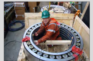
Se envuelve el rodamiento con los inductores flexibles
