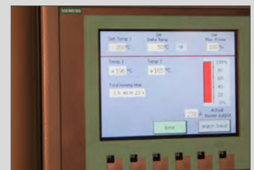
FAG Heater 5000: el proceso de calentamiento se controla con una pantalla táctil
