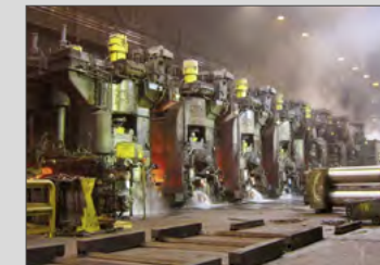
Laminador en caliente de ThyssenKrupp
