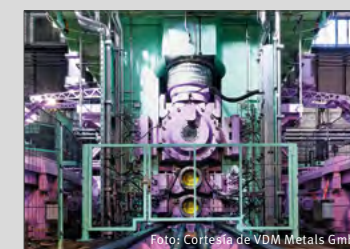
Vista lateral de la caja cuarto
