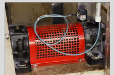
Ventilador FAG SmartCheck está montado en el rodamiento del eje
