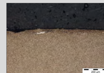
Grietas por fatiga bajo la superficie (WEC) de la pista de rodadura
