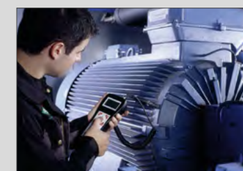
El FAG Detector III puede utilizarse para monitorizar bombas y compresores entre otros componentes
