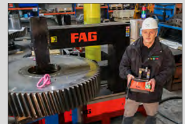
Comparación de tamaños: FAG HEATER5000, el dispositivo de calentamiento más grande jamás construido por Schaeffler junto al FAG HEATER10
