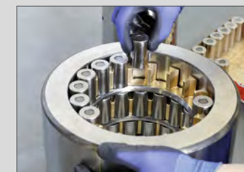
Montaje de los rodillos de apoyo
