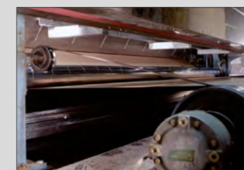
Los rodillos extensores permiten el guiado sin arrugas de las mallas de material
