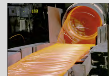
Se da forma al alambre rojo por el calor
