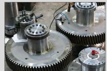
El engranaje más pesado es de casi cinco toneladas y tiene un diámetro exterior de 1 700 mm
