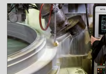
Rectificado de las pistas de rodadura
