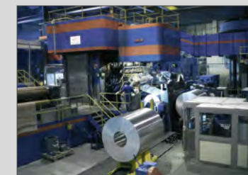
Caja cuarto de laminación en frío
