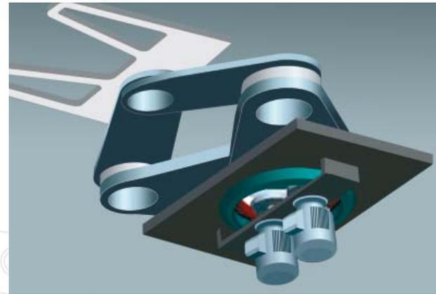
Durch den Einsatz von Dünnringlagern lassen sich Konstruktionen mit stationären Antrieben verwirklichen
