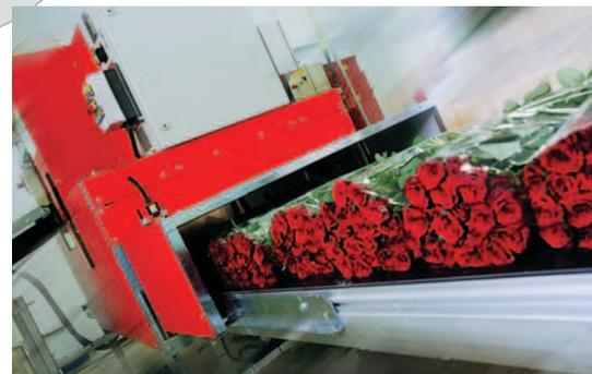
Rodamientos para largos recorridos: Los soportes INA pueden compensar bien las desalineaciones producidas en las largas cintas transportadoras
