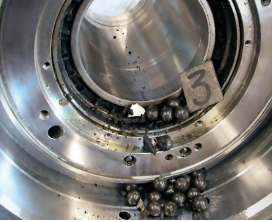
Fener mili rulmanları arızası: Personel ve makine için tehlike
