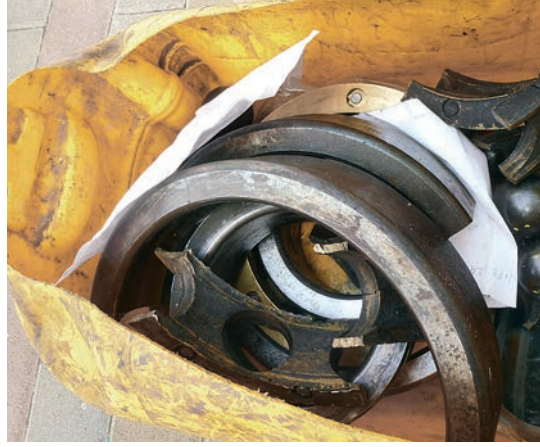
Bu sahte rulman, Akdeniz bölgesinde bir su arıtma sistemine önemli ölçüde hasar vermiştir
