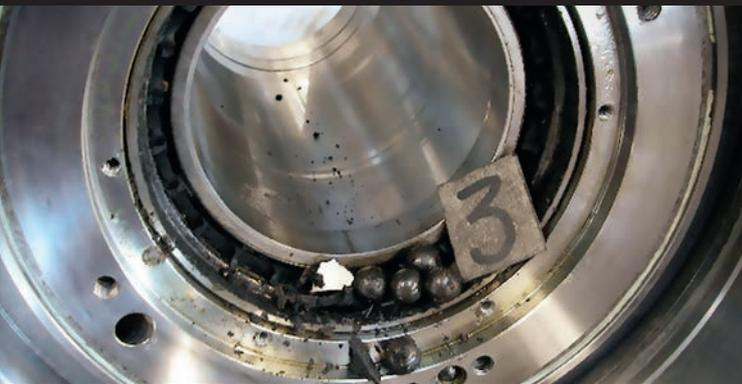
*Falha do rolamento: um risco para as pessoas e para as máquinas (Foto: Franz KESSLER)*
