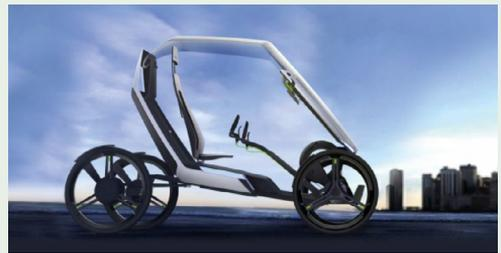
**4. BALANCE** Die Studie bietet durch ihren schwenkbaren und verstaubaren Wetterschutz das maximale Freiheitsgefühl. Mit der Kombination aus Elektroantrieb und Muskelkraft findet der Fahrer einen Mix aus Sportlichkeit und Komfort vor. Die Studie mit ausziehbarem Stauraum und Notsitz liegt nah am aktuellen Design des Bio-Hybrids.
