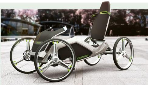
**1. WEAR** Das innovative Fahrzeugkonzept ist für die Zielgruppe Pendler konzipiert und beschäftigt sich mit der Parkplatzsuche im urbanen Raum. Durch eine leichte Rahmenstruktur und dank der Verlagerung der Antriebseinheit auf die Hinterachse ist das Konzept vertikal parkbar.
