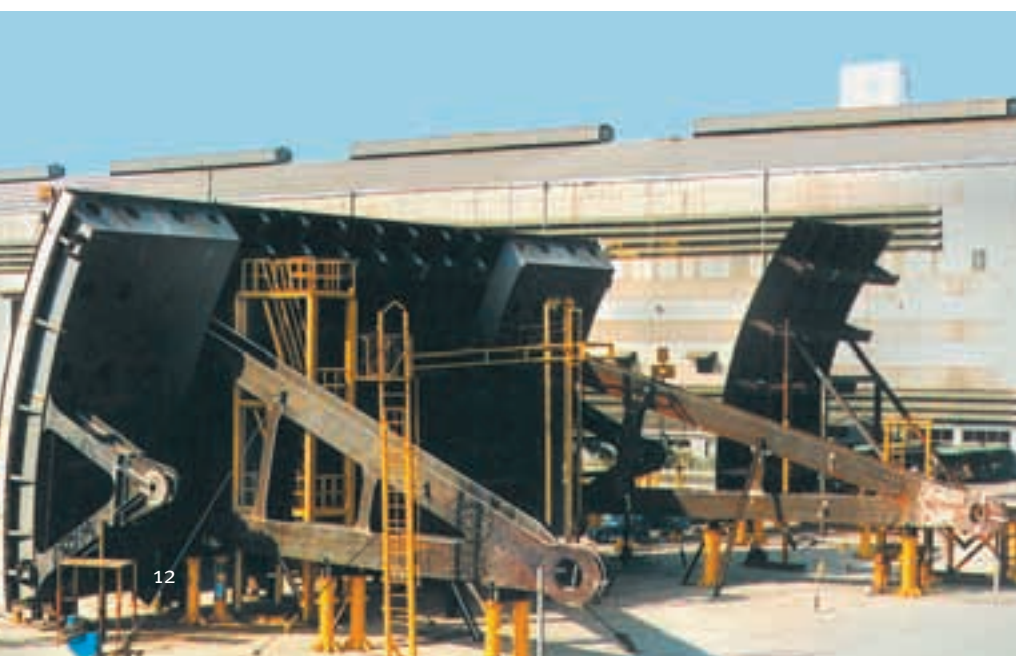
Gigantesco: as comportas de segmento da barragem de Saemangum têm 15 metros de altura e 30 metros de largura.
