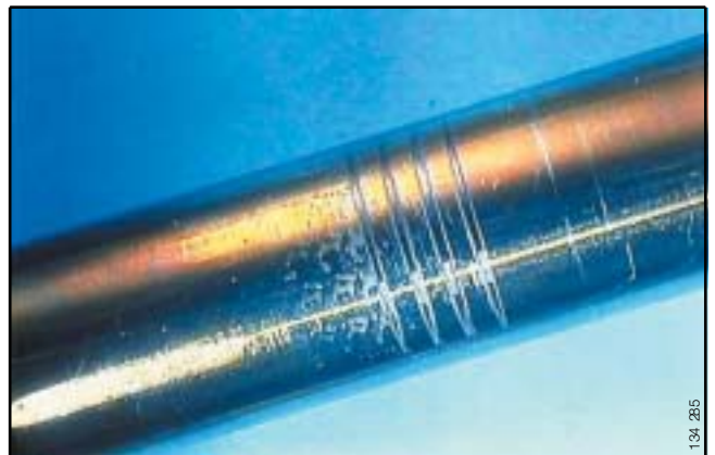
Bild 16 · Ermüdungsspuren an der Welle
