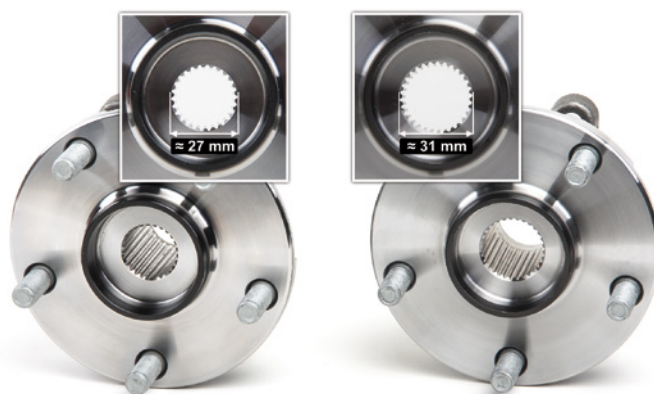
Fig. 2: De diameter van de aandrijfasopname is verschillend
