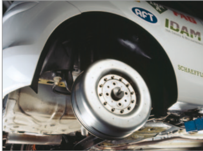
Im Schaeffler Hybrid zeigt Schaeffler den innovativen Radnabenantrieb eWheel Drive. Er macht auch vollkommen neue Fahrzeugarchitekturen möglich.
